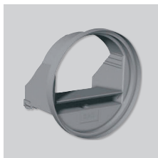
RD BP Автоматично регульовані регулятори витрати низького тиску. (20-100 Па). Встановлюються всередині повітропроводу. Діаметр 80 мм. Витрата: 15 або 30 м³/год.
